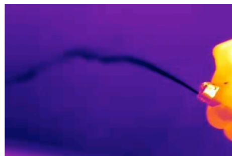
Figura 9: Fuga gas Butano de 3 gramos/hora
