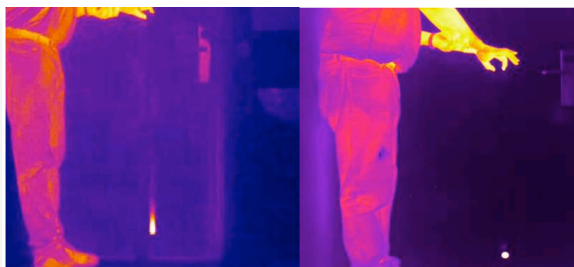
Figura 7: Imágenes con detectores con tiempos de respuesta distintos. Cortesía FLIR
