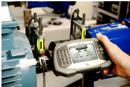
Figura 17: Sistema con doble láser, detector CCD inalámbrico, haz láser de línea. Cortesía Fixturlaser
